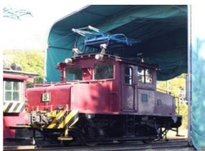
三菱造船製 20トン5号機関車。ドイツゼメンス製の20トン機関車をコピーし、大正4年に日本で製造された初期の国産電気機関車。
