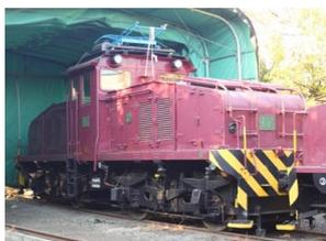
東京芝浦製作所製 45トン17号機関車。石炭の産出量増大に伴い増備された東芝製の国産機。「戦時標準型」の第1号機として製造、これをプロトタイプとして、後年、各地の私鉄に供給。
